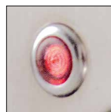
Témoin lumineux de mise sous tension.
