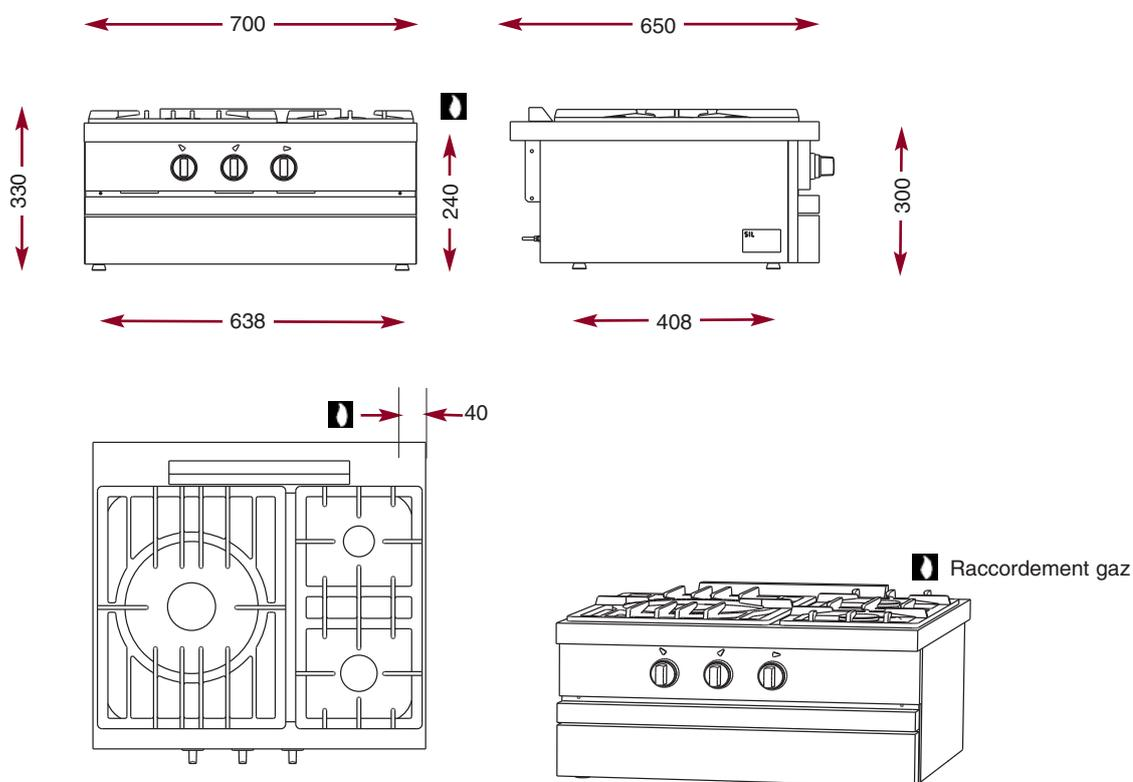
À fonction équivalente, les modules présentent les mêmes caractéristiques techniques et les mêmes performances que les modules sur armoires. Ils sont conçus pour être posés sur des supports adaptés en tube inox, mais ils peuvent tout aussi bien être installés sur des plans en inox ou encore sur un support carrelé.
