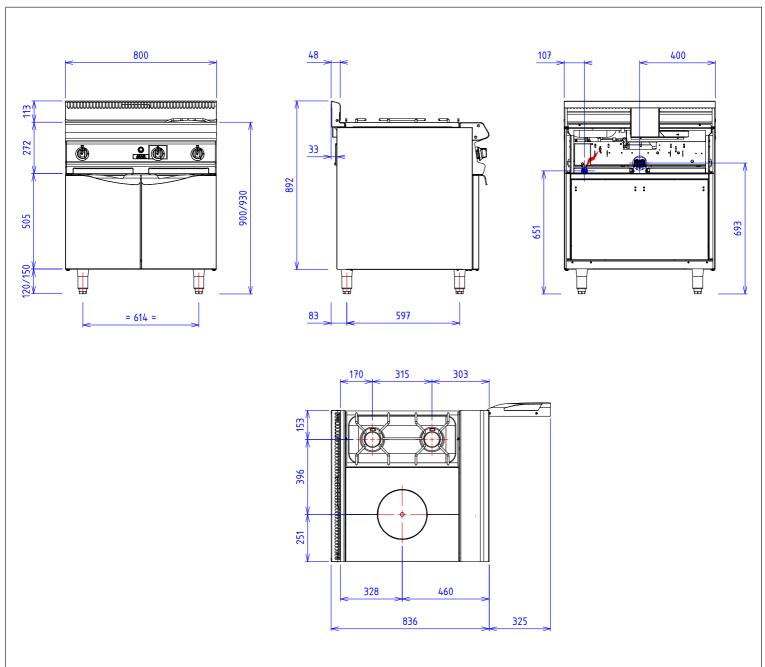
**GAZ:** Puissance gaz : 20kW Raccord gaz :15/21 conique
