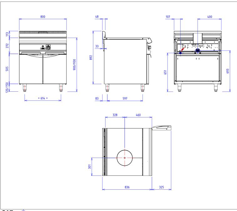
**GAZ:** Puissance gaz: 8kW Raccord gaz: 15/21 conique
