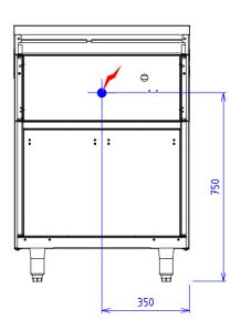
**ELEC:**  $\checkmark$  230V Mono +T si option prise électrique
