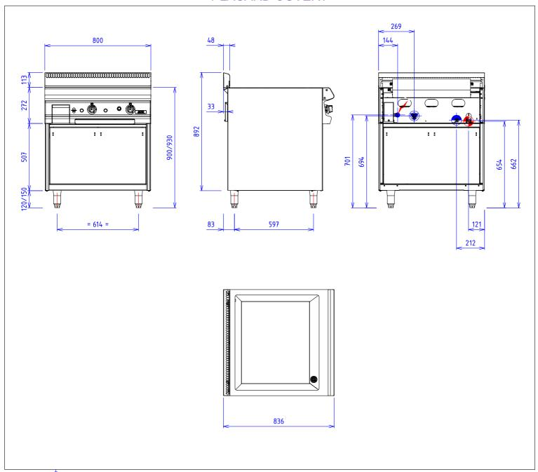
**GAZ:** • Puissance gaz : 9kW Raccord gaz :15/21 conique
