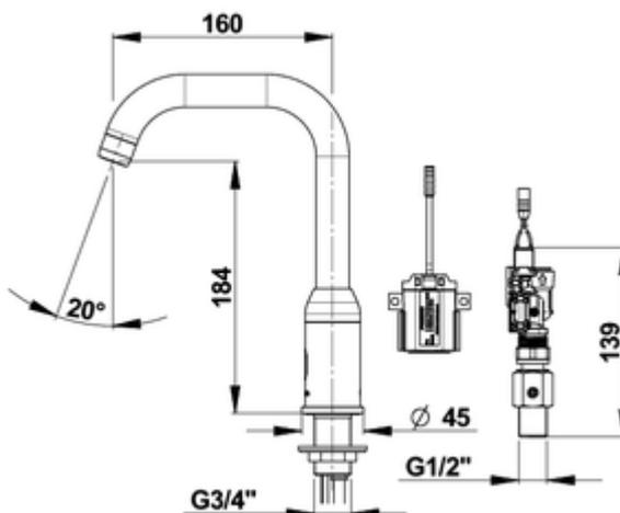
Avec pile lithium 6 V CRP2 dans boîtier déporté IP65 | Réf. 55451
