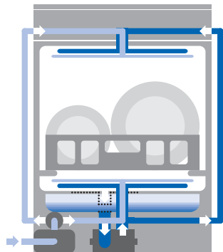
Conduite d'eau pour le système à surchauffeur
