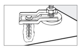
Avec les pattes de fixation, l'appareil est fixé au sol par les pieds. Le matériel de fixation est prévu pour une fixation par goujons sur le sol en béton.
